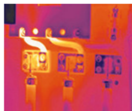
Conexión de alta resistencia
